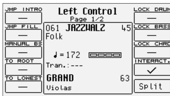
**F1 JUMP INTRO:** travaille en combinaison avec les boutons **INTRO 1, 2, 3**. S'il est actif, il permet à l'Arrangeur en position Stop et après l'appui d'un des trois boutons **INTRO**, le démarrage de l'Arrangeur avec la seule reproduction des mesures de l'Ending correspondant. Avec l'Arrangeur en exécution, en appuyant un des boutons **INTRO 1, 2, 3**, l'Arrangeur jouera les mesures de l'Intro sélectionné et il poursuivra avec l'Arrange actif à ce moment.
