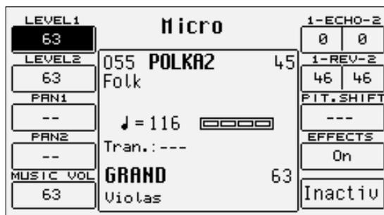
**F1 LEVEL 1:** établit le volume du micro à l'entrée Mic 1. Après avoir sélectionné le paramètre par le bouton fonction, on peut varier sa valeur par les boutons **VALUE +/-** dont l'appui simultané met à zéro la valeur.
