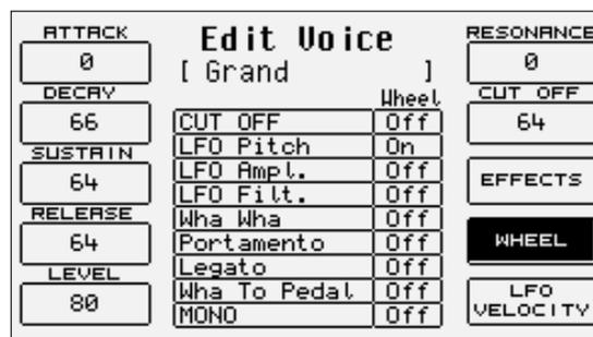
En Appuyant sur **F9 Wheel**, l'écran affiche une table à deux colonnes où la première montrera le paramètre et la deuxième l'état d'activation pour la Modulation Wheel. Pour sélectionner n'importe quel paramètre ou colonne on emploie les boutons **CURSOR +/-** et on insère la modification par les boutons **VALUE +/-**. Ci-dessous vous trouverez la description de chaque paramètre:
